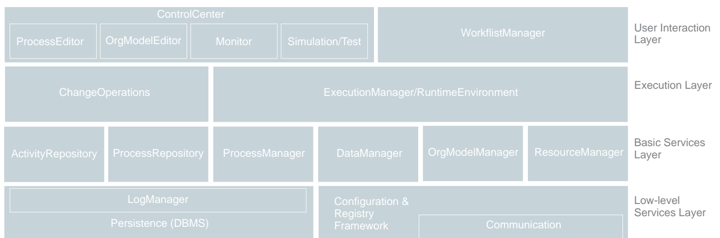
Die Schichtenarchitektur der AristaFlow BPM Plattform
